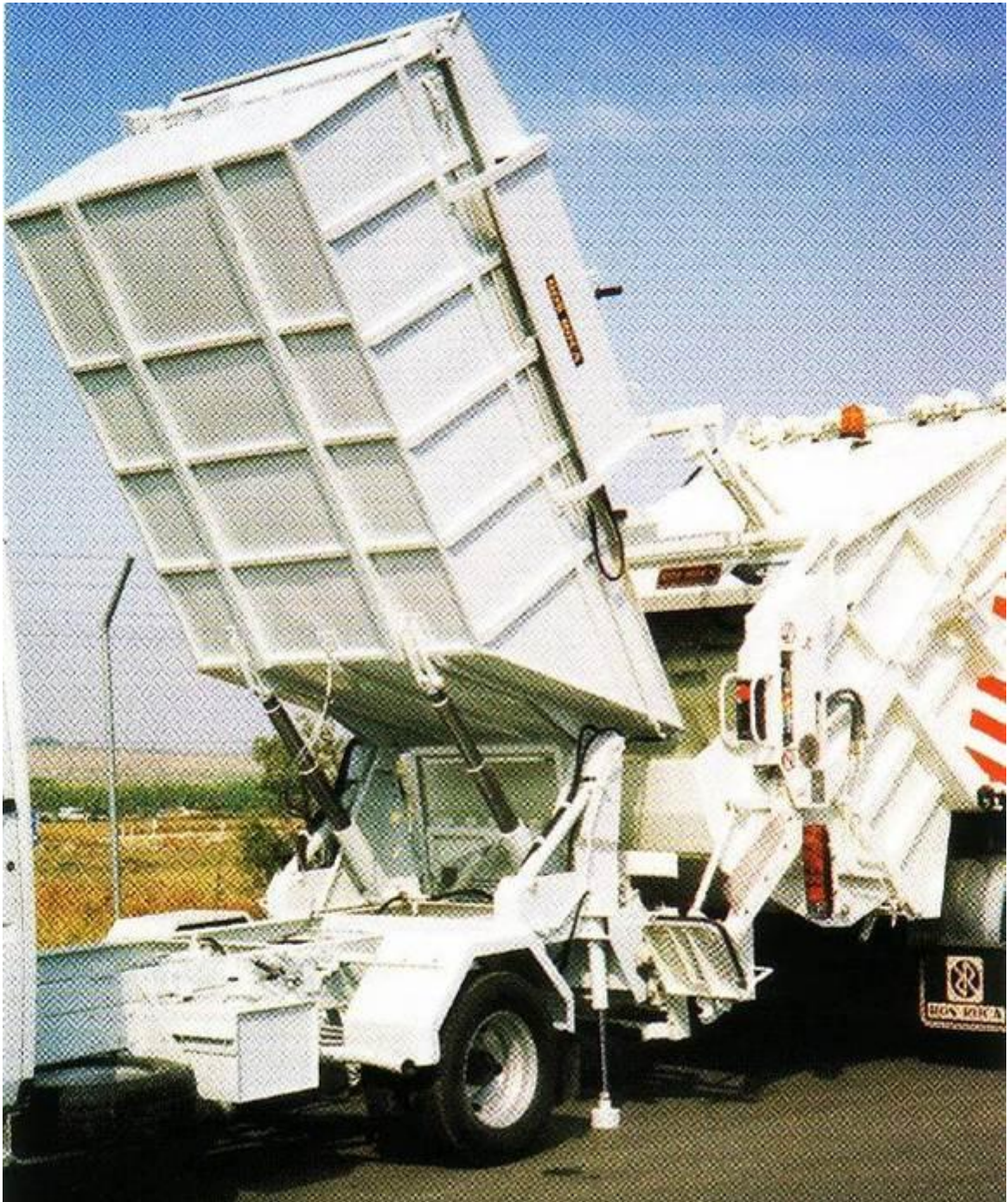
Vehículo recolector nodriza, sobre el que descarga un vehículo satélite.
